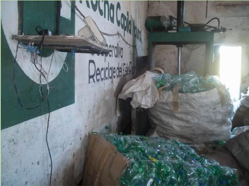
PRENSA Y BALANZA QUEDARON BAJO EL AGUA, RODEADAS DE FARDOS Y BOLSONES QUE FLOTARON. LA MARCA DEL AGUA SE APRECIA EN LA PARED, EN LA PARTE INFERIOR DE LA PALABRA RECICLAJE.
