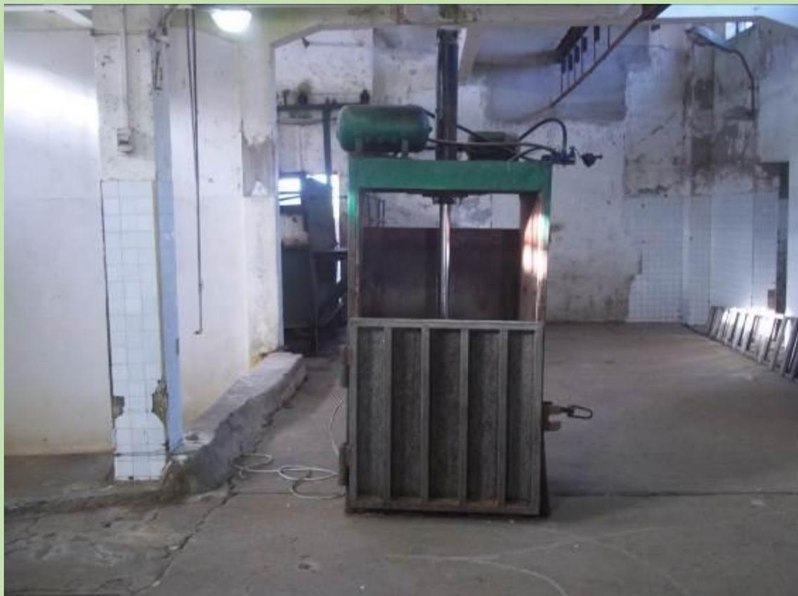
***PRENSA Y PLATAFORMA CONSTRUIDA PARA LA PRENSA.***
